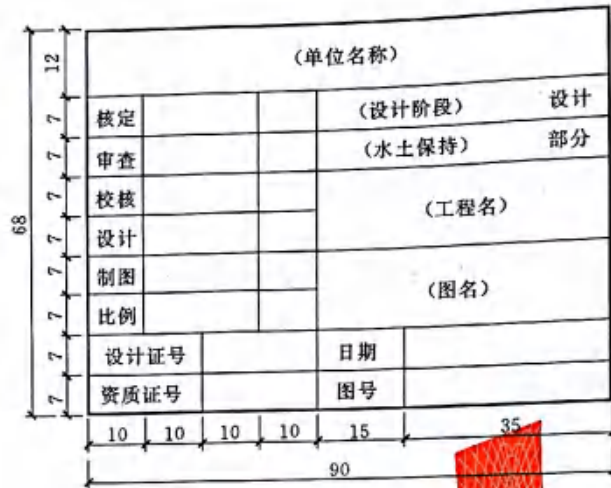
图 3.0.3-3 标题栏 (A2~A4 图幅) (单位: mm)
